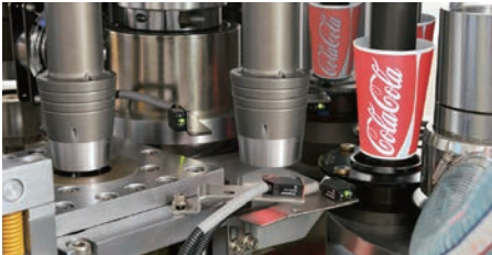
冲底部分 BOTTOM PUNCHING & DRAWING
