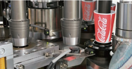
冲底部分 BOTTOM PUNCHING & DRAWING
