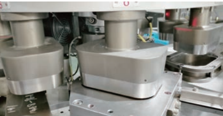
冲底部分 BOTTOM PUNCHING & DRAWING
