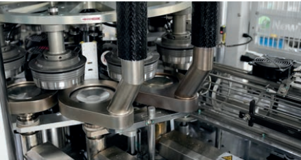
杯底加热部分 BOTTOM HEATING
