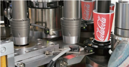
冲底部分 BOTTOM PUNCHING & DRAWING
